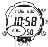
Indicateur de commutateur d'éclairage automatique en service
