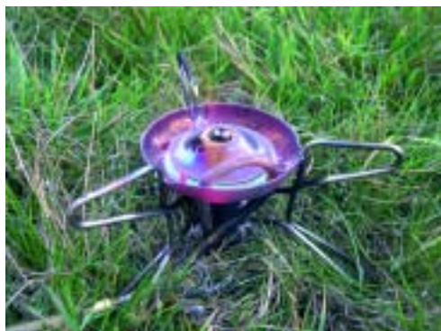
La belle flamme bleue et chaude obtenue après la phase de préchauffage sur un réchaud à essence, on voit bien le tuyau d'alimentation qui passe sur le foyer
