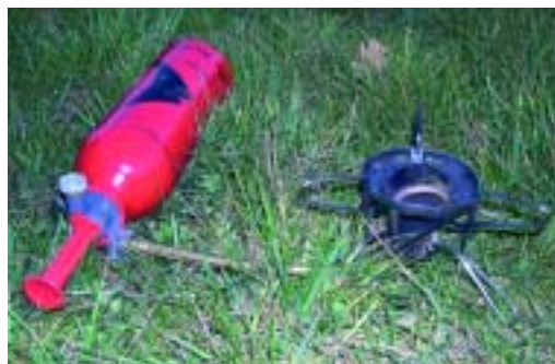
Ensemble d'un réchaud à essence, on voit le "bouchon pompe" de la bouteille de combustible
