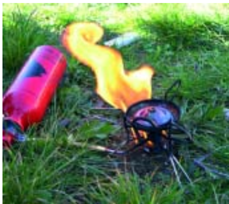
La phase de préchauffage accompagnée de ses grandes flammes jaunes
